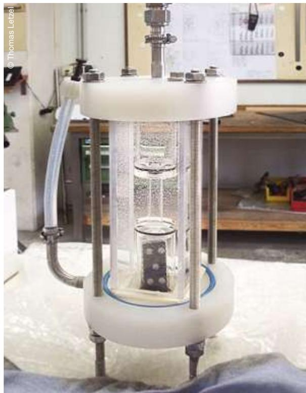
Messzelle mit Diamantelektroden
